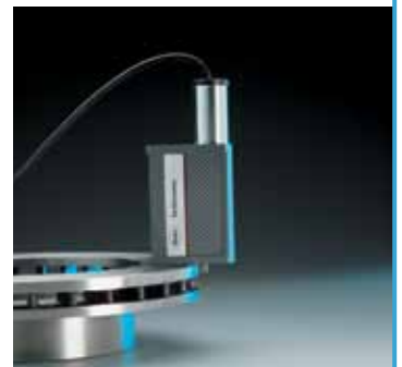
Misurazione in appoggio frontale
